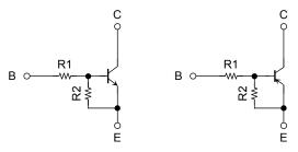
Q1 (R1:  $47k\Omega$ , R2:  $47k\Omega$ ) Q2 (R1:  $4.7k\Omega$ , R2:  $47k\Omega$ )
